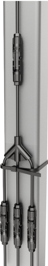
正确布线示意图 Correct wiring diagram
